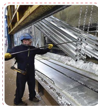
Galvanisation à chaud
